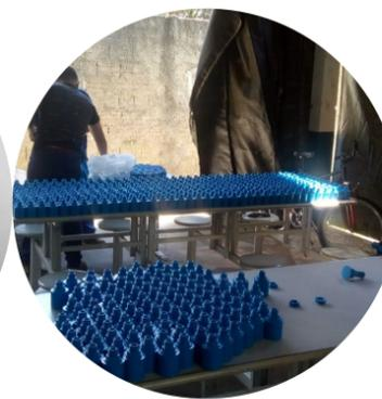
**CREPINAS PARA TANQUES DE FILTRAGEM DE ÁGUA**
